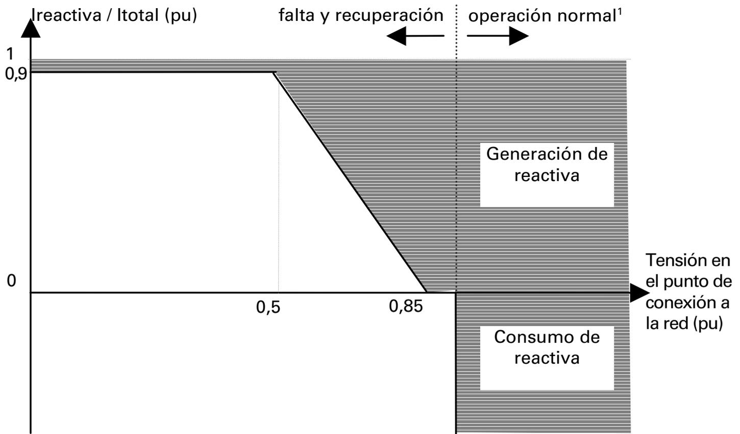
Figura 4.2 Área de funcionamiento admisible durante los periodos de falta y de recuperación de tensión, en función de la tensión en el punto de conexión a red.
