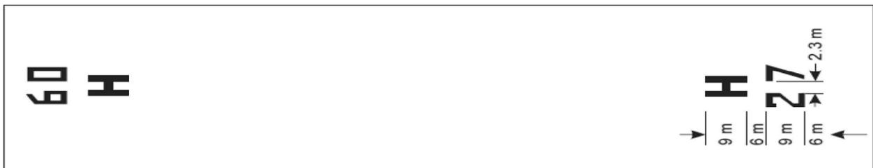
Figura 4.2.1.-2. Señal de designación de la FATO y señal de identificación de helipuerto para FATO de tipo pista de aterrizaje
