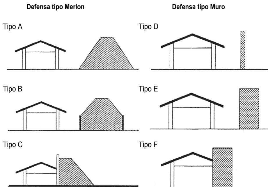
Los muros deben estar calculados para resistir, sin vuelco, el efecto de la onda de choque.
