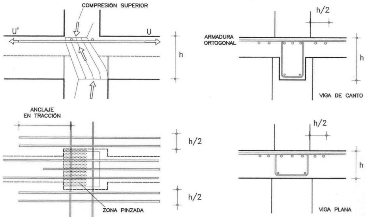
Figura 4.11. Armaduras de continuidad en nudo interior
