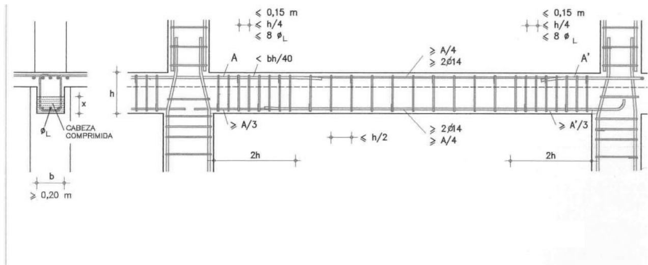
**Figura 4.4. Requisitos de vigas para ductilidad alta ( $\mu = 3$ ).**
