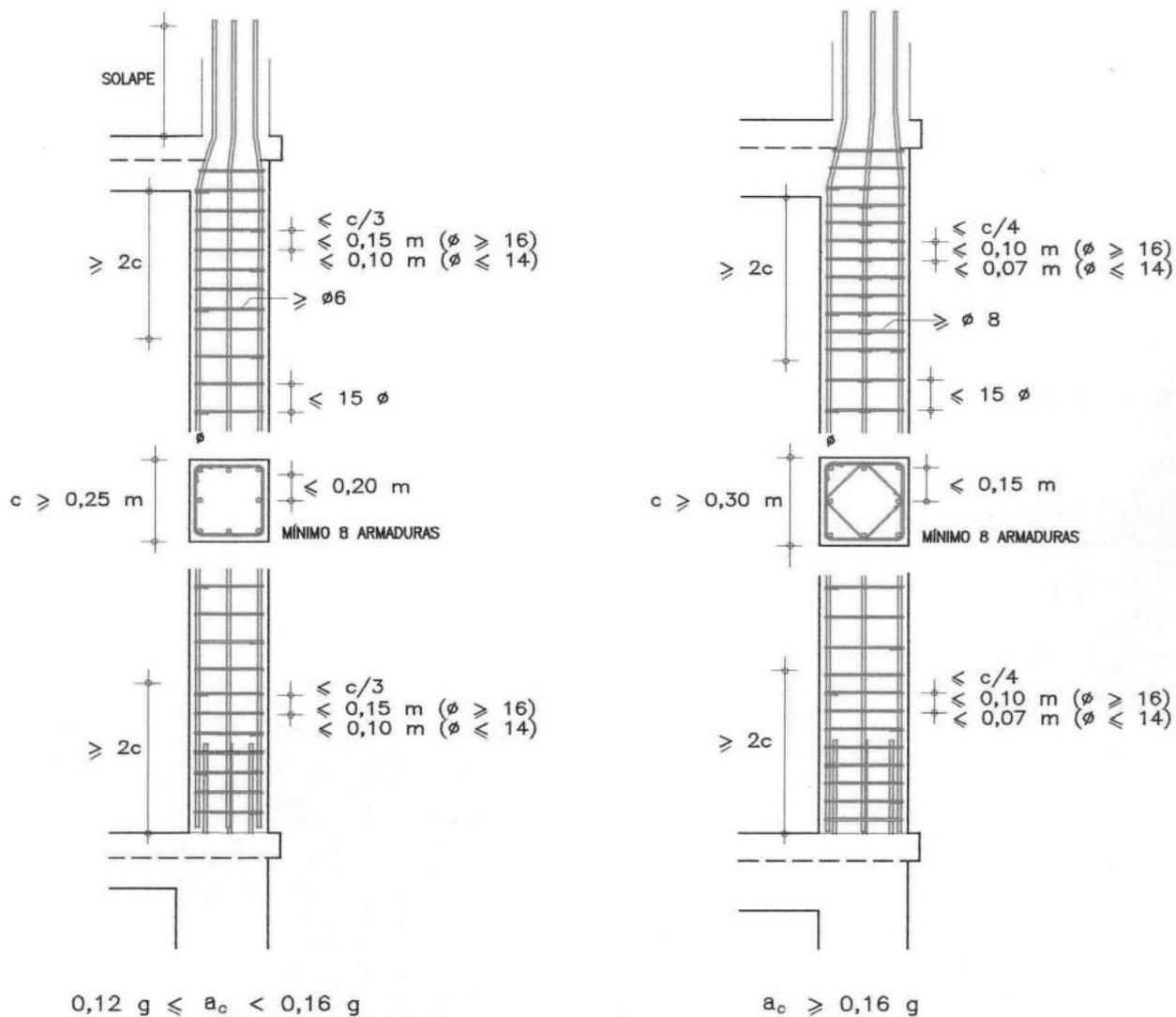
**Figura 4. 16. Armado de soportes de hormigón.**
