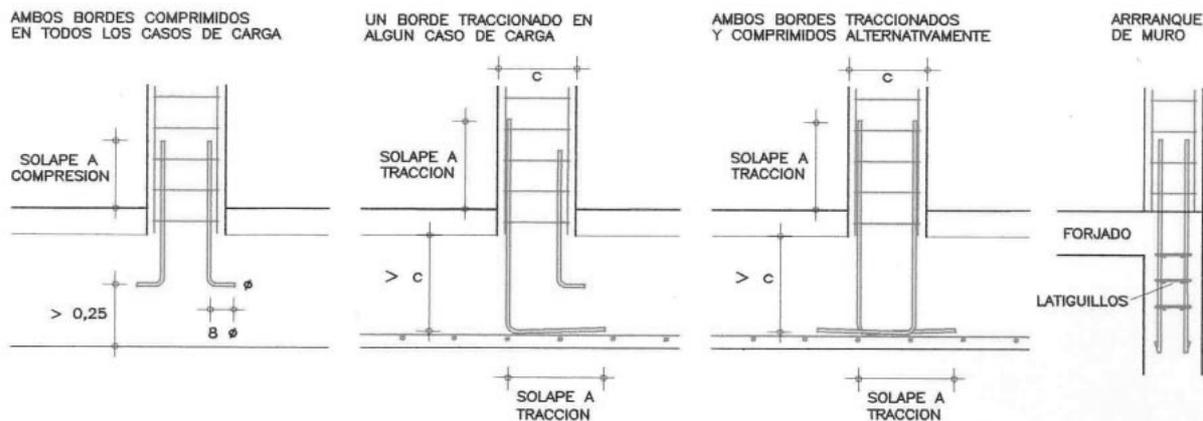
**Figura 4.17. Arranque de armaduras de espera de soporte.**
