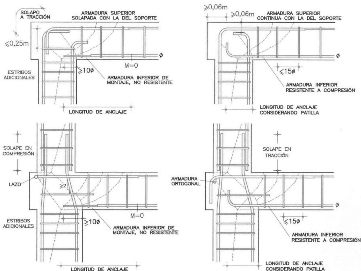
Figura 4.10. Disposición de armaduras en nudo extremo.
