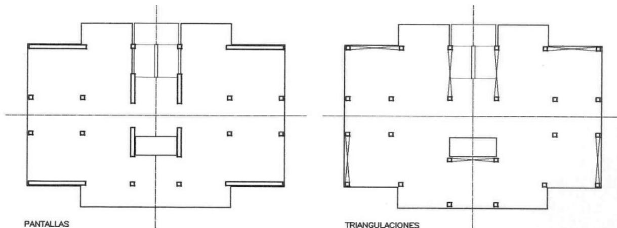
**Figura 4.2. Disposiciones de elementos resistentes.**
