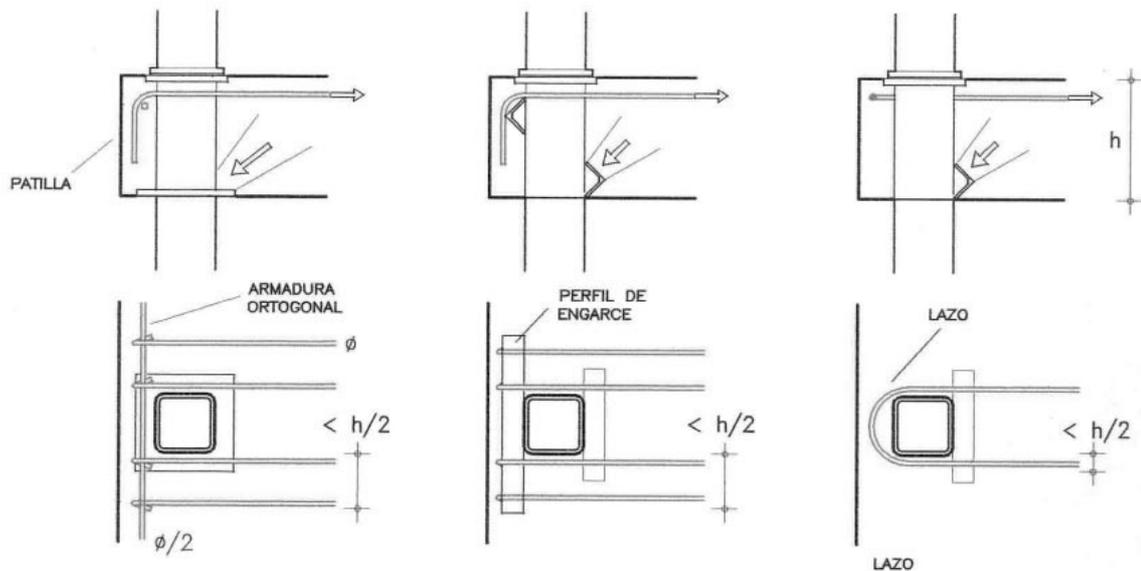
**Figura 4.9. Armaduras superiores en nudo extremo con soporte metálico.**
