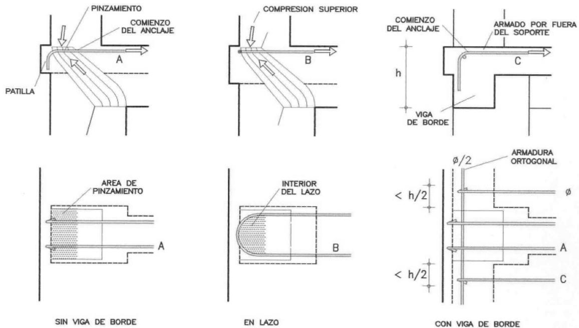
**Figura 4.8. Armaduras superiores en nudo extremo con soporte de hormigón.**
