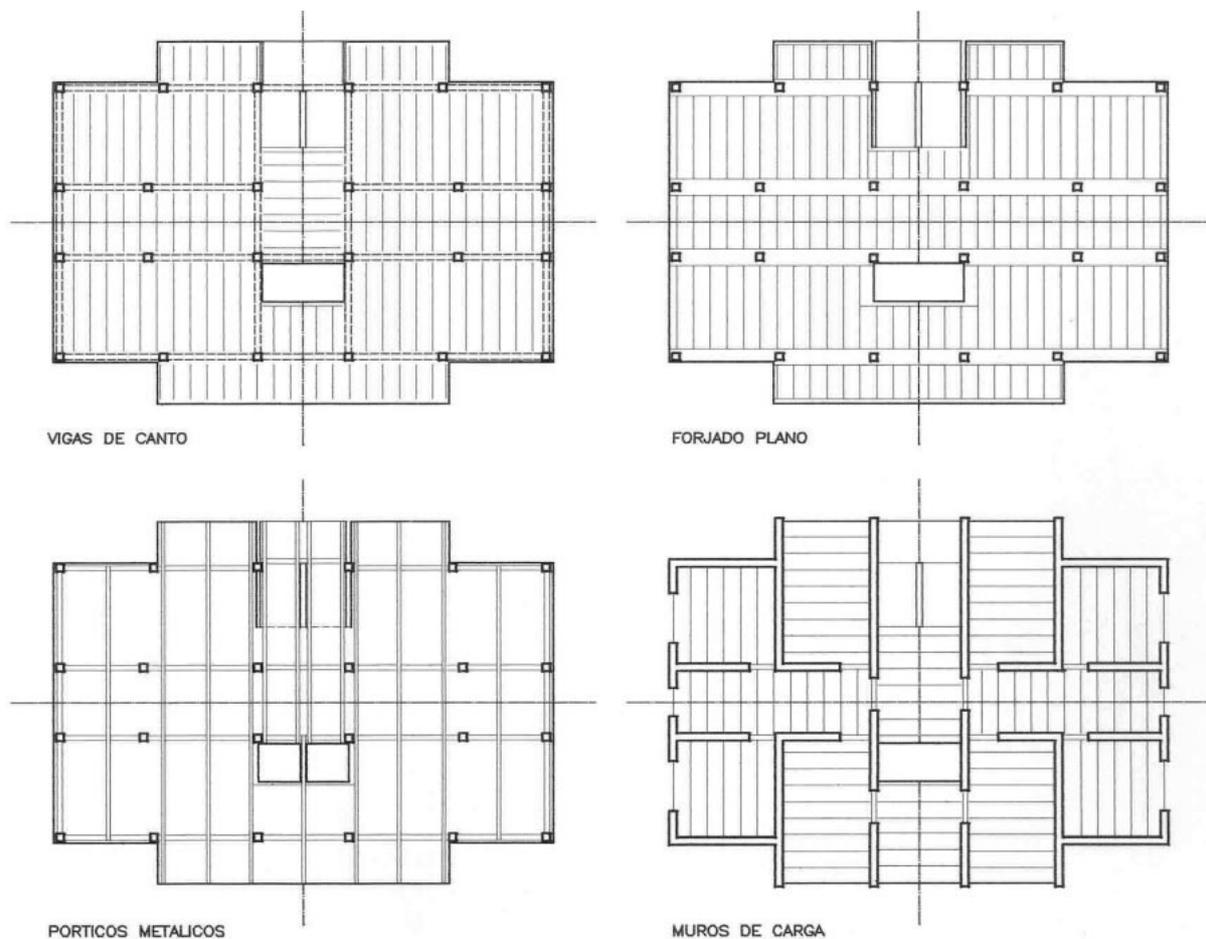
*Figura 4.1. Disposiciones con simetría geométrica y mecánica.*
