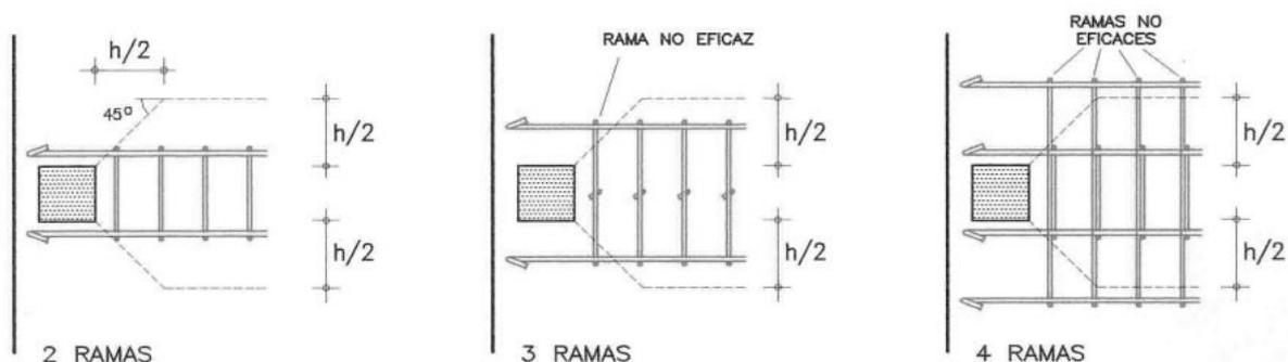
**Figura 4.13. Ramas de estribos computables a cortante.**
