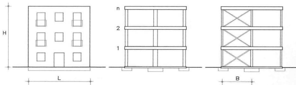
**Figura 3.2. Esquema de los diferentes tipos de estructuras.**
