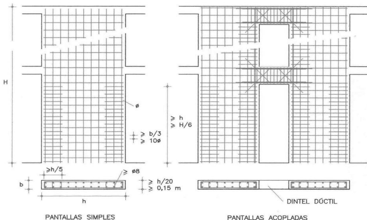
*Figura 4.21. Armado de pantallas.*
