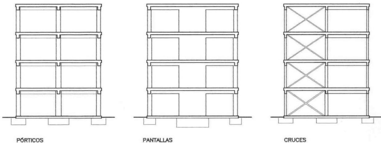
**Figura 3.5.- Ejemplos de organizaciones estructurales que permiten un valor del coeficiente de comportamiento por ductilidad  $\mu = 3$ .**
