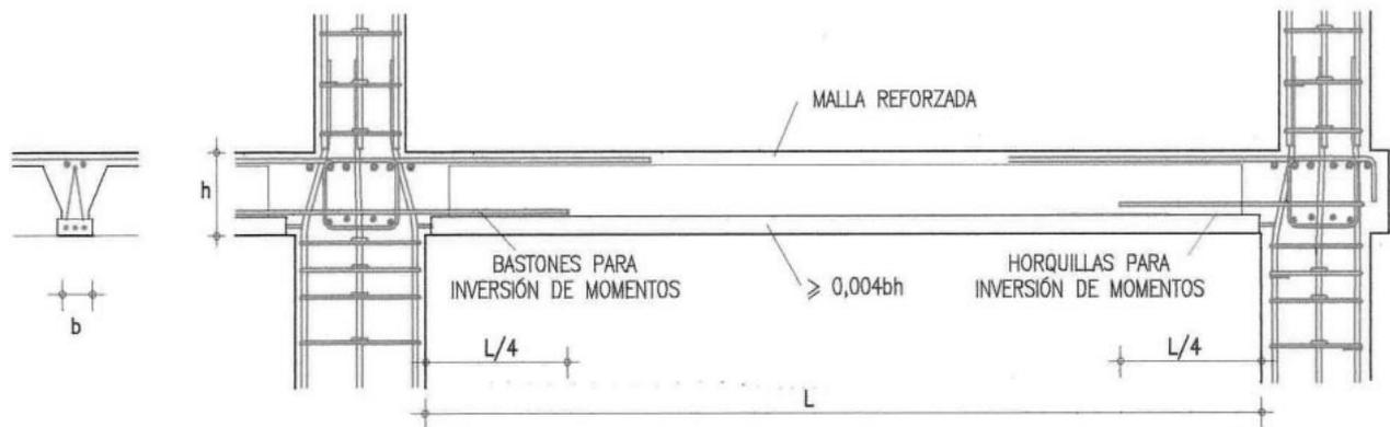
**Figura 4.20. Requisitos de forjados para  $a_c \geq 0,16$  g.**
