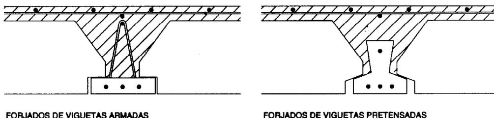
Figura 2.2 Tipos usuales de forjados de vigüetas
