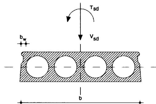
Figura 14.5 Esfuerzo cortante y torsor o cortante excéntrico
