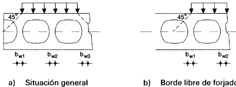
Figura 14.4 Ancho efectivo en losas alveolares pretensadas
