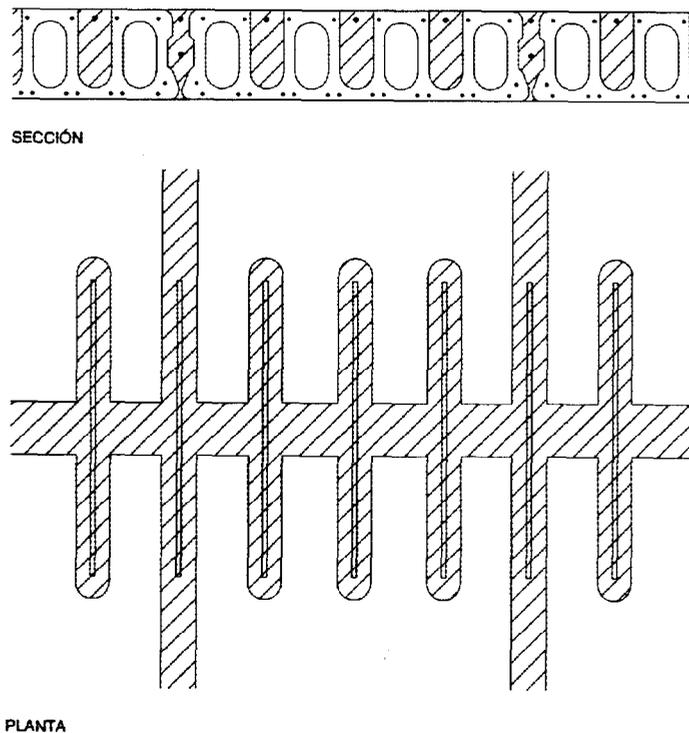
Figura 22.b Armadura superior en losas alveolares pretensadas
