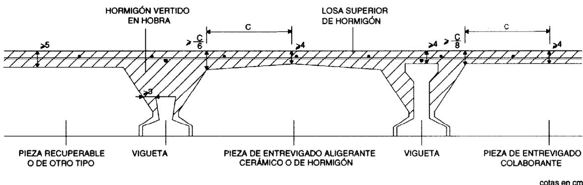
Figura 17.a Condiciones geométricas de los forjados
