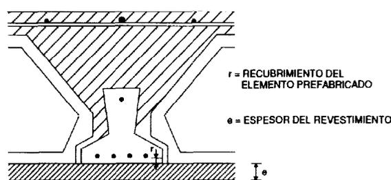
Figura 10.2 Recubrimiento de las armaduras activas
