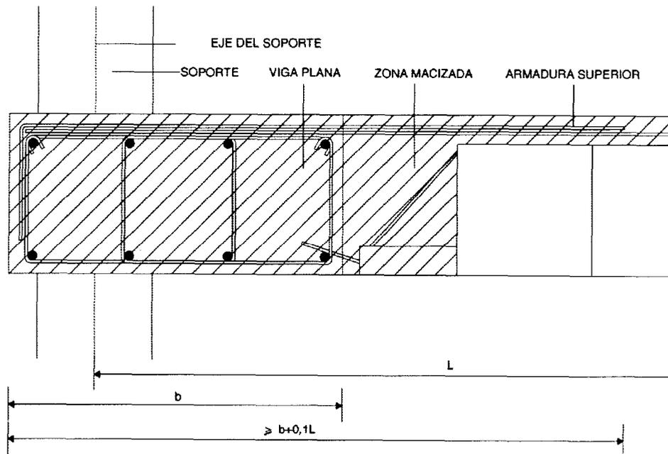
Figura 22.a Anclaje de armadura superior en extremo
