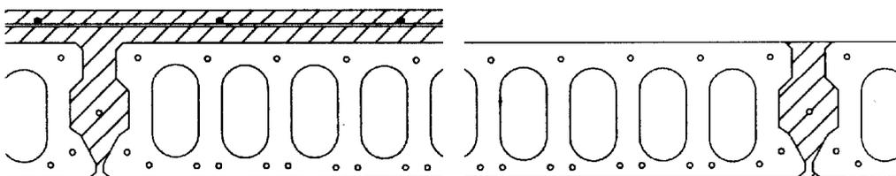
Figura 2.3 Tipos usuales de forjados de losas alveolares pretensadas
