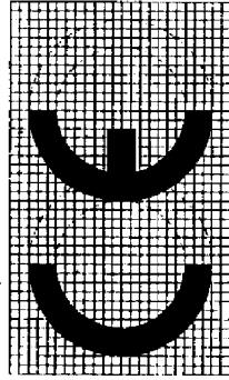
En caso de que el tamaño del marcado CE se amplíe o reduzca en función del tamaño de la máquina, se respetarán las proporciones indicadas en el dibujo anterior. Los distintos elementos del marcado CE deberán tener básicamente la misma dimensión vertical, que no podrá ser inferior a 5 mm.
