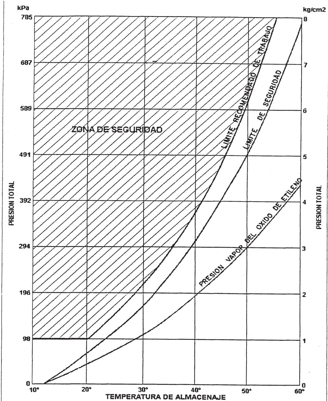
Figura 1.- CONDICIONES DE TRABAJO DEL OXIDO DE ETILENO
