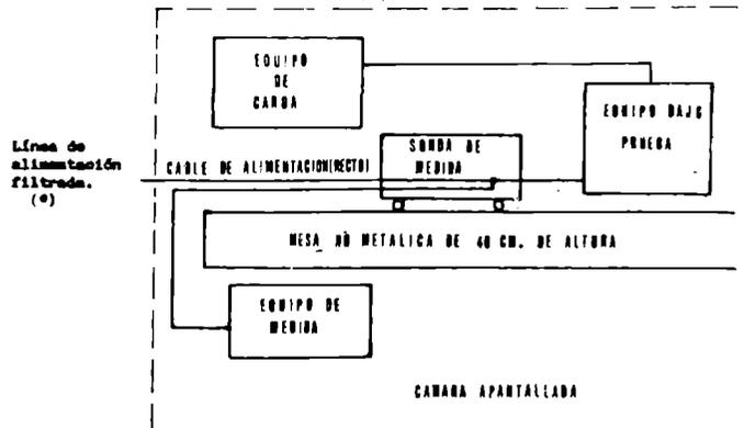
(\*) Los filtros de radiofrecuencia (RF) de la línea de alimentación tendrán una atenuación mínima de 100 dB en el margen de frecuencia de las medidas.
