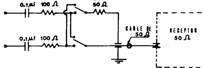
2. La red en V se conectará a los terminales de la clavija de entrada de los cables de alimentación, situándose a 80 centímetros del aparato bajo prueba, plegando en zig-zag la longitud en exceso del citado cable.
