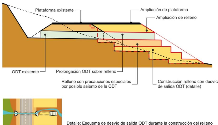
FIGURA 5.4.- EJEMPLO DE PROLONGACIÓN DE ODT SOBRE RELLENO
