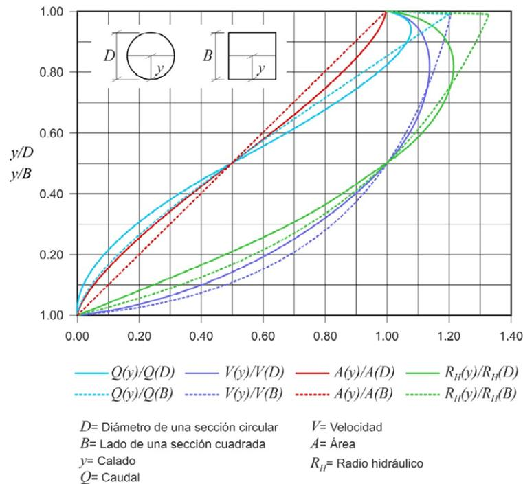
FIGURA 3.38.- CAUDAL EN FUNCIÓN DEL CALADO EN ELEMENTOS LINEALES EN LÁMINA LIBRE EN RÉGIMEN UNIFORME
