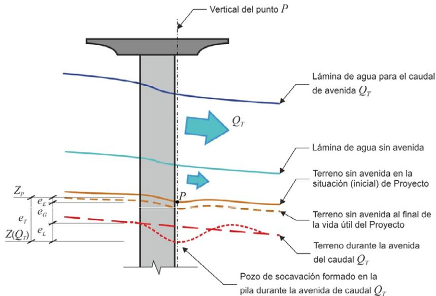
Nota: La situación del punto  $P$  de mayor profundidad de erosión depende de la sección transversal de la pila
