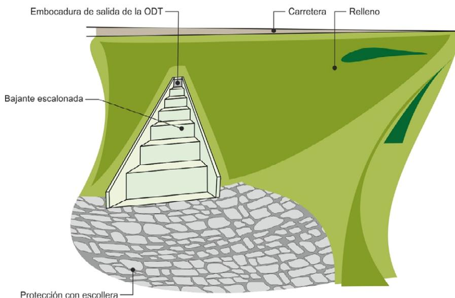
FIGURA 4.16 EJEMPLO DE EMBOCADURA CON BAJANTE ESCALONADA
