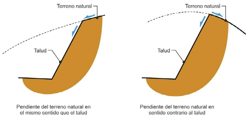
FIGURA 3.18 PENDIENTE DEL TERRENO NATURAL Y DEL TALUD
