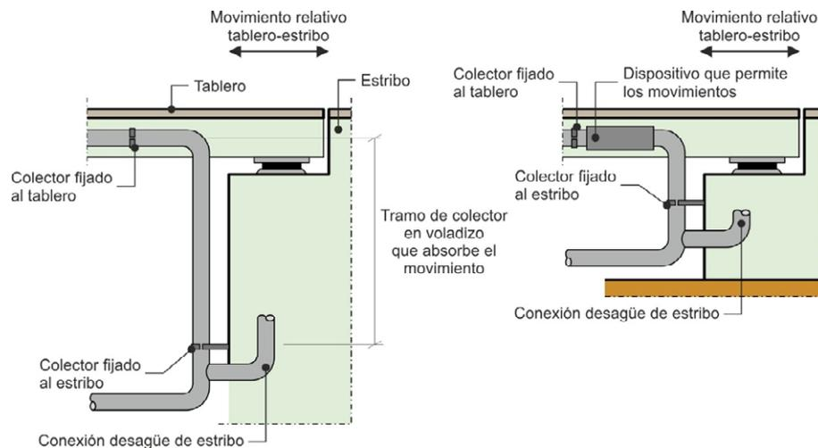
FIGURA 3.28 EJEMPLO DE CONEXIÓN DE COLECTORES EN ESTRIBOS
