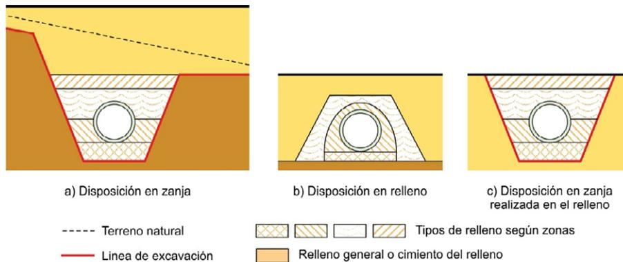
FIGURA 4.19 ENCAJE DE LA ODT EN EL RELLENO
