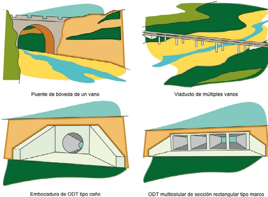
FIGURA 4.1.- EJEMPLOS DE PUENTES Y ODT
