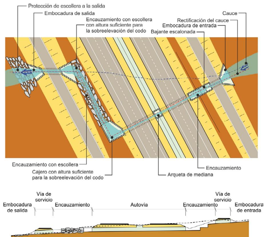
FIGURA 4.7.- EJEMPLO DE ODT COMPUESTA DE VARIOS TRAMOS.
