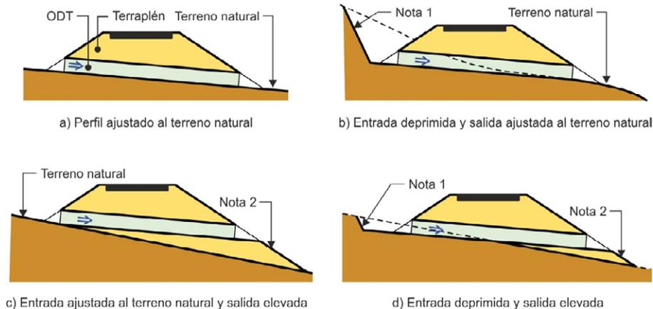
Nota 1: la entrada deprimida o en desmonte requiere una definición especial de la embocadura de entrada.
