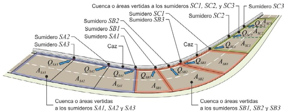
$$\text{Capacidad sumideros } (S_{B1} + S_{B2} + S_{B3}) \geq 2 \cdot [Q_{SB1} + Q_{SB2} + Q_{SB3} + 0,3 \cdot (Q_{SA1} + Q_{SA2} + Q_{SA3} + Q_{SC1} + Q_{SC2} + Q_{SC3})]$$
