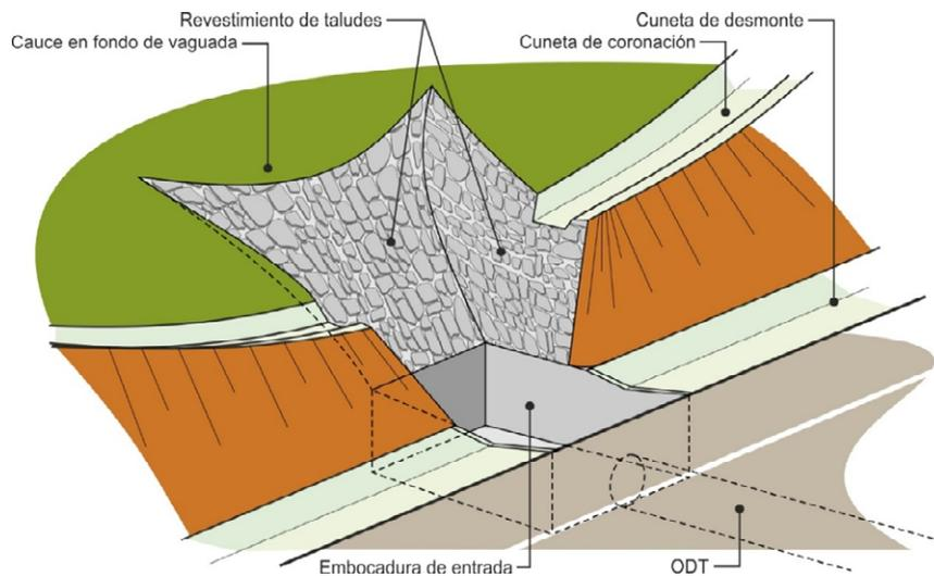
FIGURA 4.17 EJEMPLO DE EMOCADURA DE ENTRADA EN UNA SECCIÓN EN DESMONTE
