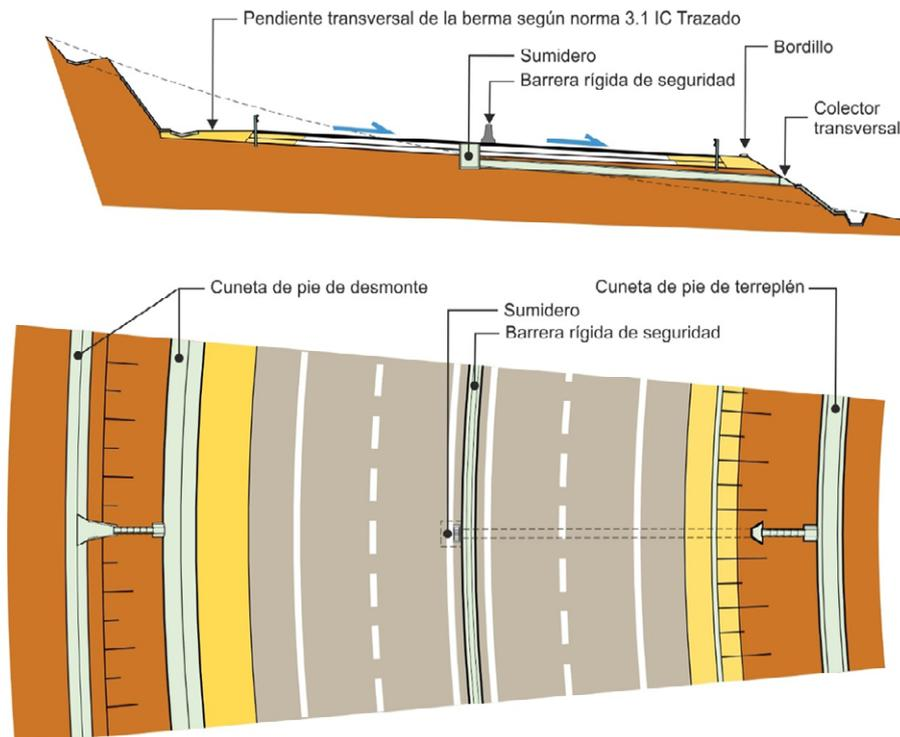
FIGURA 3.15 SUMIDERO CON DESAGÜE A COLECTOR TRANSVERSAL
