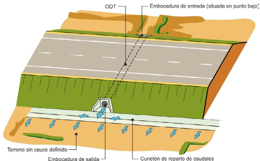
FIGURA 4.29.- EJEMPLO DE CUNETÓN DE REPARTO DE CAUDALES
