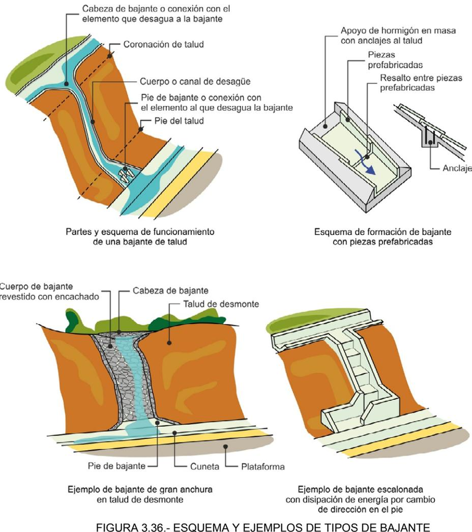
FIGURA 3.36.- ESQUEMA Y EJEMPLOS DE TIPOS DE BAJANTE
