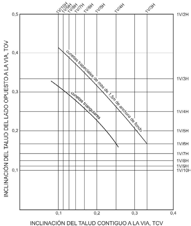
FIGURA 3.17 TALUDES DE CUNETAS EN MARGEN DE DESMORTE
