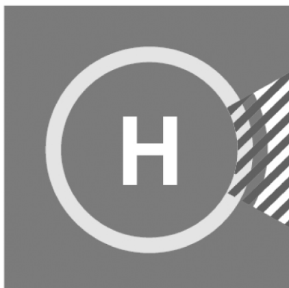
Figura 5-5. Senyal del sector d'aterratge prohibit en l'heliplataforma
