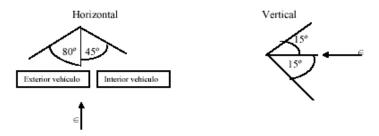
∈ eje de referencia paralelo al eje del vehículo y dirección del vehículo.
