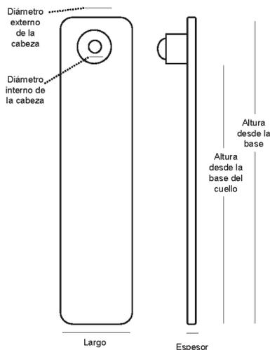
**Ilustración —3** Detalle de crotal rectangular —pieza hembra
