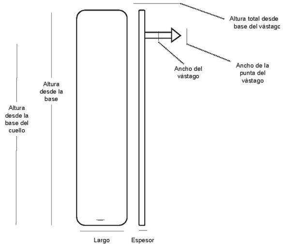
**Ilustración —4** Detalle de crotal rectangular —pieza macho
