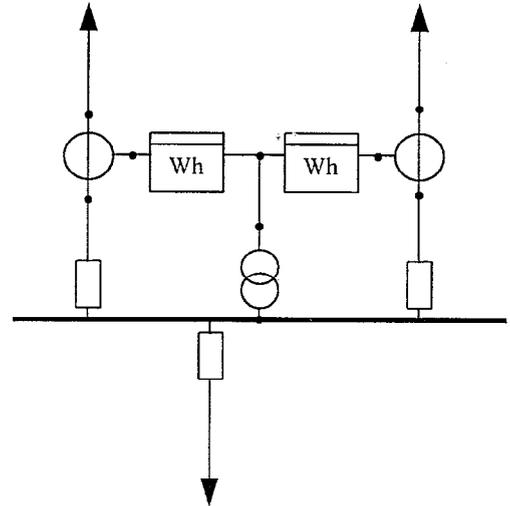
La medida de tensión en barras no es admisible en configuraciones de interruptor y medio. El ejemplo muestra una de las formas admisibles para esta configuración (con medida de tensión en las líneas).
