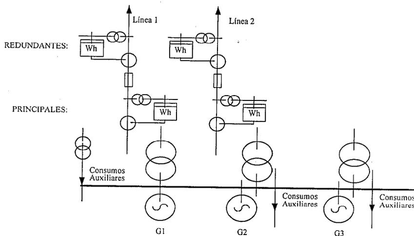
13.2.3 Medida comprobante en bornas de alternador: La siguiente configuración es conforme a lo especificado en estas instrucciones para los casos en que se permite utilizar la medida en bornas de alternador como comprobante de la medida de energía neta, en sustitución del requisito de redundancia.
