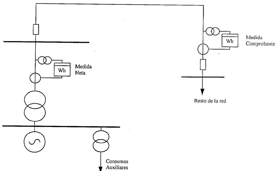
13.2.5 Medida comprobante en la frontera transporte-distribución: La siguiente configuración es conforme a lo especificado en estas instrucciones para los casos en que se permite utilizar la medida en alta como comprobante en la frontera transporte-distribución.
