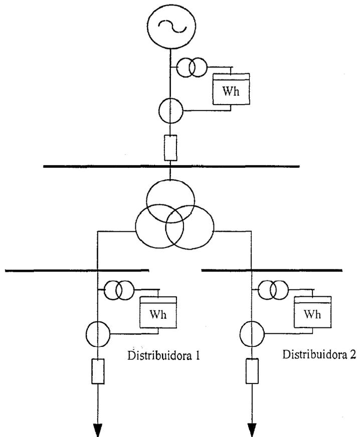
13.2.2 Medida comprobante en las líneas de salida de generación: La siguiente configuración es conforme a lo especificado en estas instrucciones para las fronteras de generación cuando se instalan las medidas comprobantes en las líneas. La figura muestra la medida de tensión en líneas, si bien podría estar en barras.
