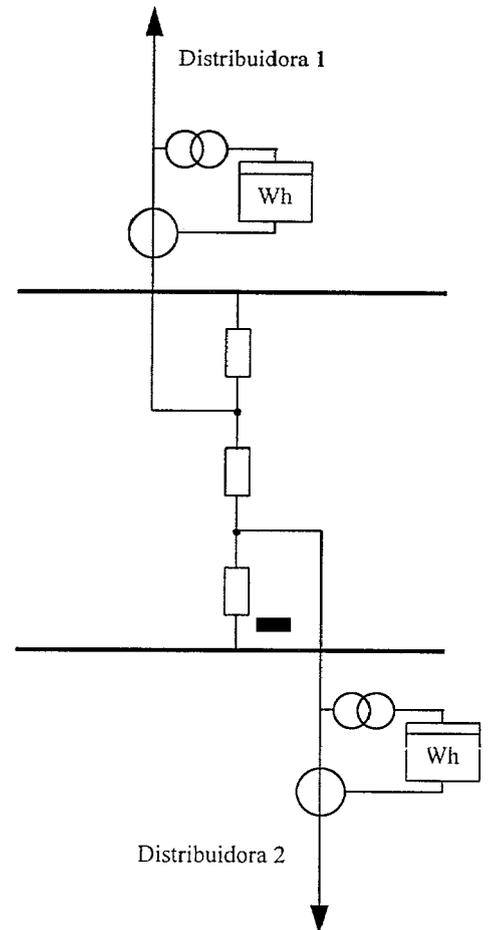
Cuando la configuración sea redundante, será necesario disponer de dos medidas de tensión en barras, una para los principales y otra para los redundantes.
