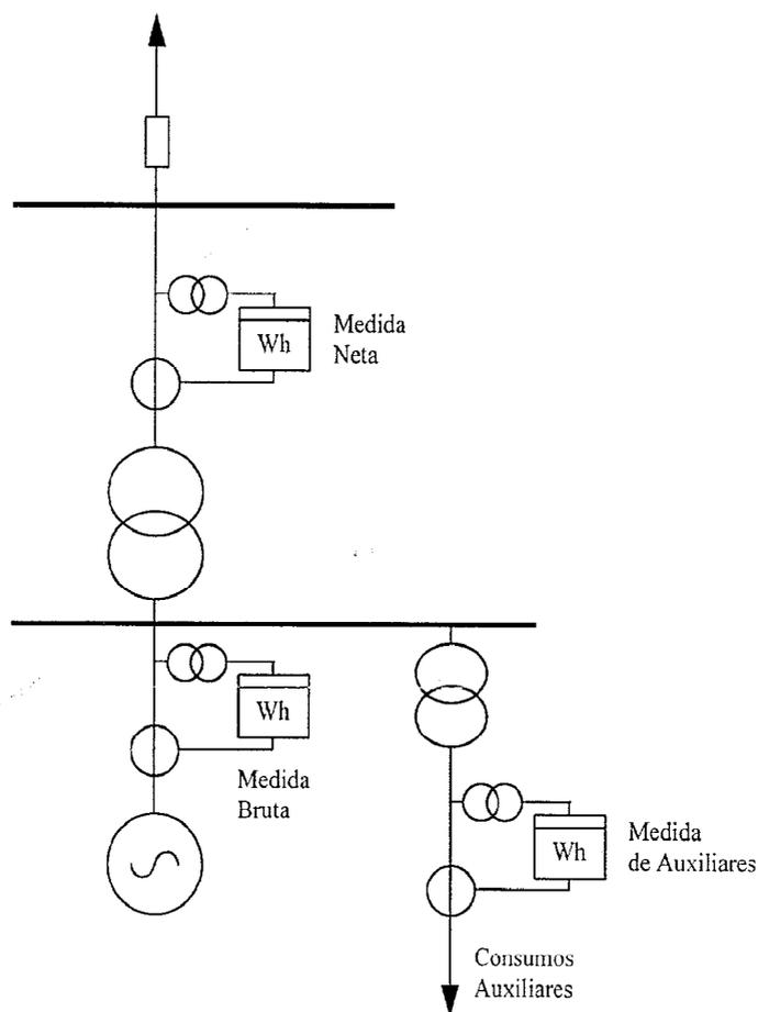
13.2.4 Medida comprobante en antenas puras de generación: La siguiente configuración es conforme a lo especificado en estas instrucciones para los casos en que se permite utilizar la medida comprobante al otro extremo de la línea (centrales en antena pura de generación), en sustitución del requisito de redundancia:
