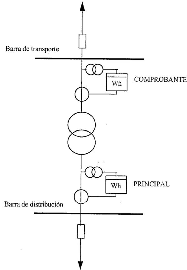
13.2.6 Medida comprobante en antenas puras de demanda: La siguiente configuración es conforme a lo especificado en estas instrucciones para los casos en que se permite utilizar la medida comprobante al otro extremo de la línea (clientes en antena pura de demanda), en sustitución del requisito de redundancia:
