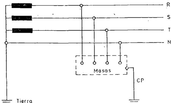
Fig. 6 Esquema TT
