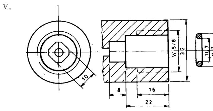
ACOPLAMIENTO W15/8 - 16 Hilos/Pulgada (DERECHAS) TIPO CLORO (BOTELLONES)
