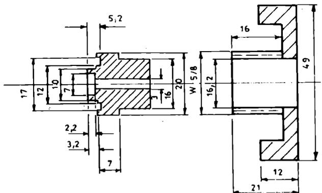
ACOPLAMIENTO W15/8 - 16 Hilos/Pulgada (DERECHAS) TIPO CLORO (BOTELLONES)
