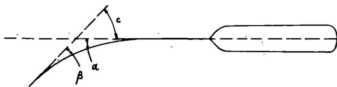
Figura 3.—Determinación del ángulo de deformación permanente
