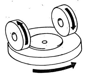
Figura 4.-Esquema del abrasimetro
