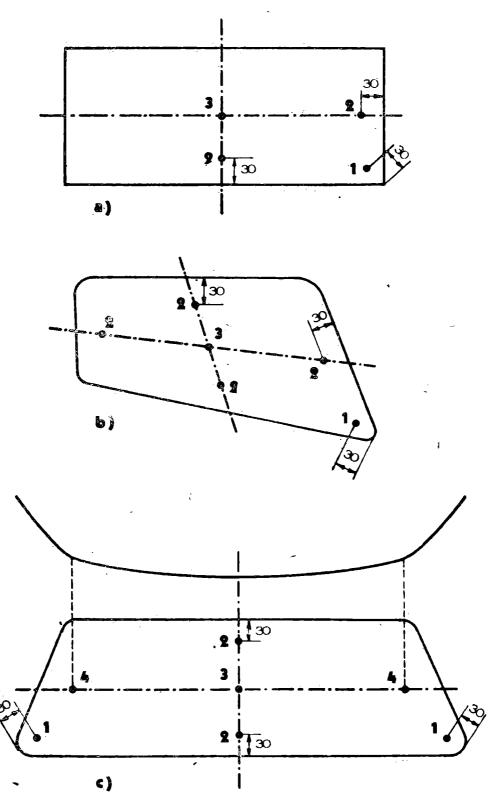
Figura 23.—Puntos de impacto prescritos para los cristales laterales 3 para la luneta trasera
