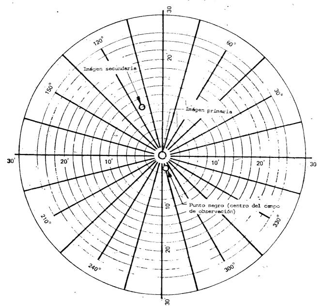
Figura 20.—Ejemplo de observación según el método de ensayo con el colimador
