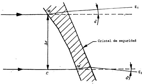
Figura 12.-Representación esquemática de la distorsión óptica
