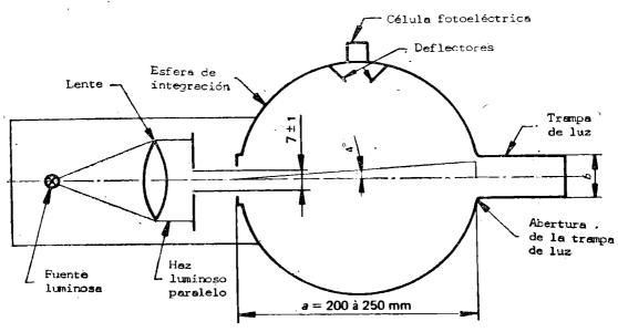
Figura 5,-Aparato para medir la atenuación de la visibilidad
