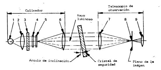
Figura 19.—Aparato para el ensayo con el colimador
