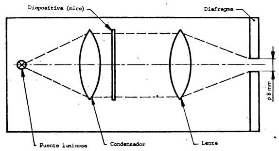
Figura 13.-Esquema óptico del proyector
