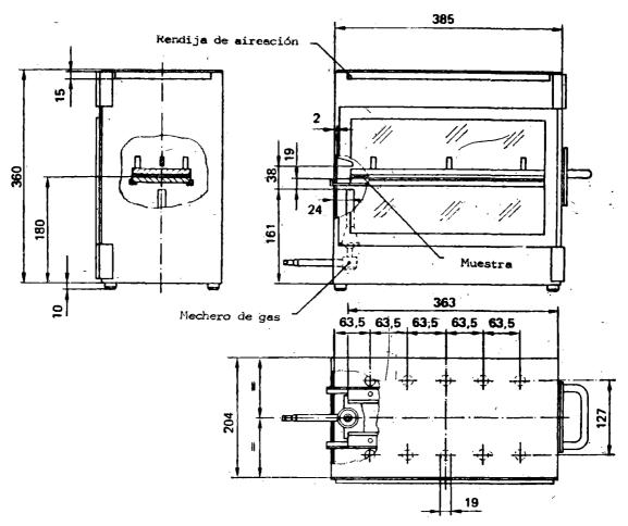
Figura 7.-Ejemplo de cámara de combustión
