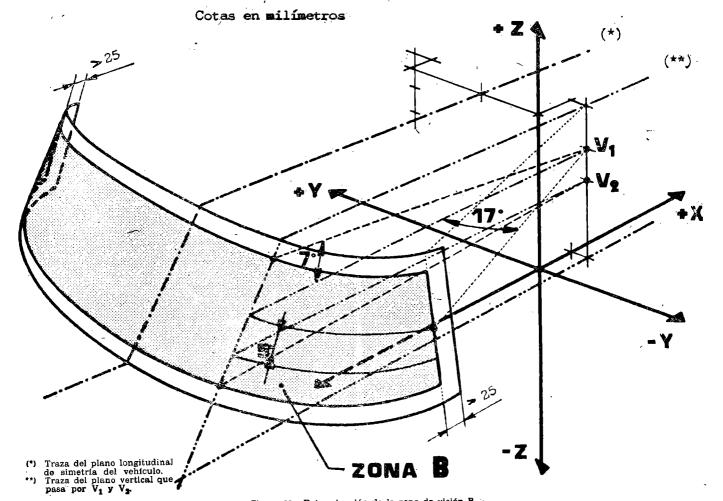
Figura 28.—Determinación de la zona de visión B 🕟
