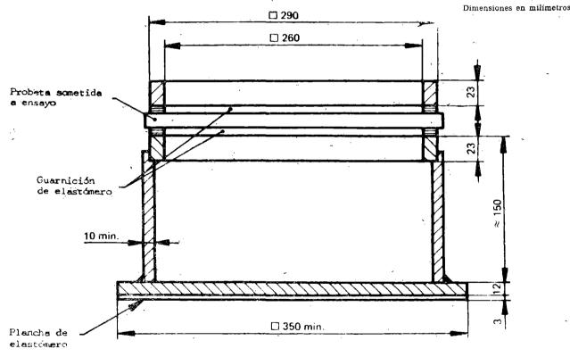
Figura 1.-Soporte para ensayos de caída de bola
