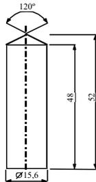
Fig.2: Pistón cilíndrico de bronce, dimensiones en mm.
