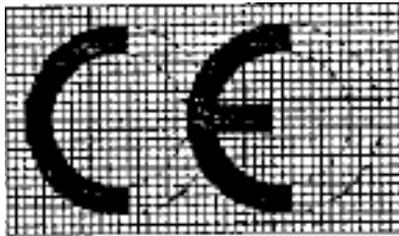
El marcado CE deberá tener una altura de al menos 5 mm. Si el marcado CE se reduce o amplía, deberán respetarse las proporciones indicadas en el anterior dibujo graduado.
