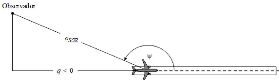
La función  $\Delta_{SOR}$  representa la variación del ruido total que produce el desplazamiento en tierra firme antes del despegue medido detrás el punto de partida de rodaje, en relación con el ruido total del desplazamiento en tierra firme antes del despegue medido en el lateral del punto de partida de rodaje, a la misma distancia:
