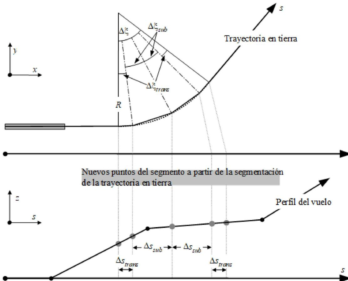
Una vez que se han definido los segmentos de la trayectoria en tierra en el plano x-y, los segmentos del perfil de vuelo (en el plano s-z) se superponen para obtener los segmentos de la trayectoria tridimensional (x, y, z).
