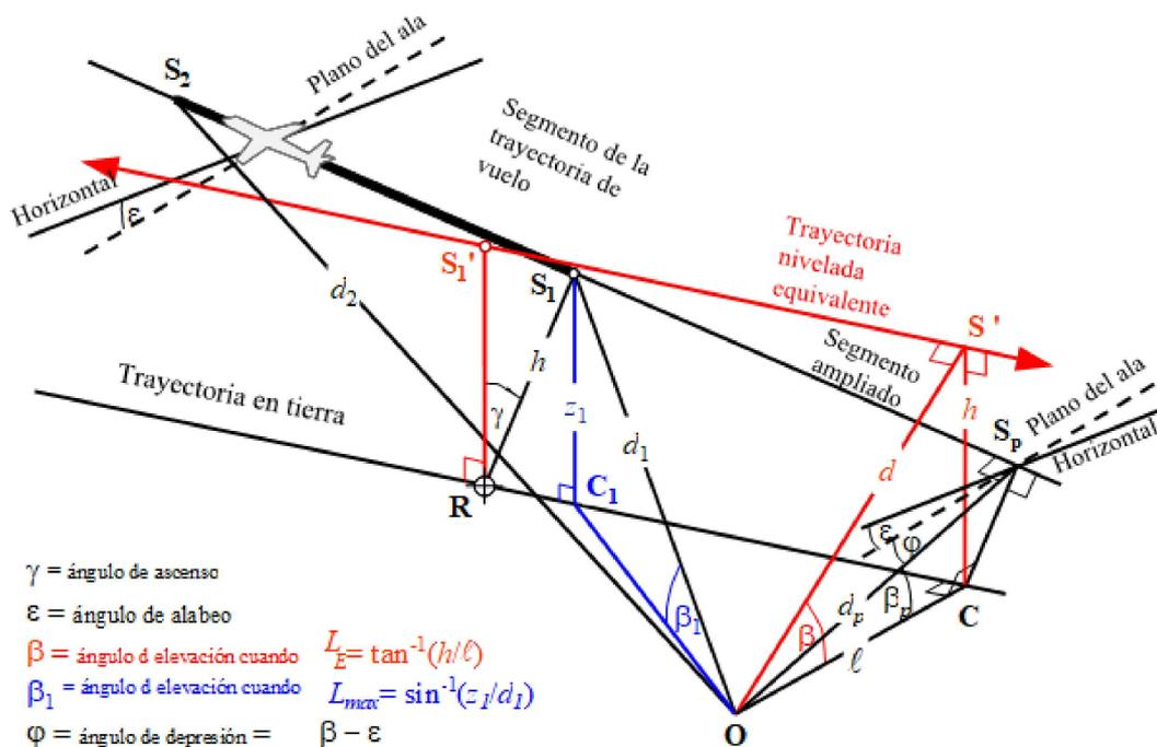
Para métricas de nivel máximo, el parámetro de distancia NPD se considera la distancia más corta hasta el segmento, es decir,  $d = d_1$ . Para las métricas del nivel de exposición, se trata de la distancia más corta  $d_p$  de  $O$  a  $S_p$  sobre la trayectoria de vuelo ampliada; es decir, el nivel interpolado desde el cuadro de NPD es  $L_{E\infty}(P_1, d_p)$ .
