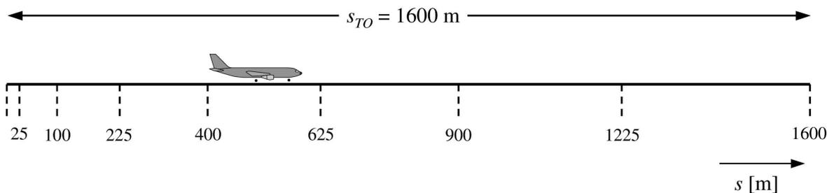
Al igual que sucede con los cambios de velocidad, el empuje de la aeronave cambia a lo largo de cada segmento mediante un incremento constante  $\Delta P$ , que se calcula como:
