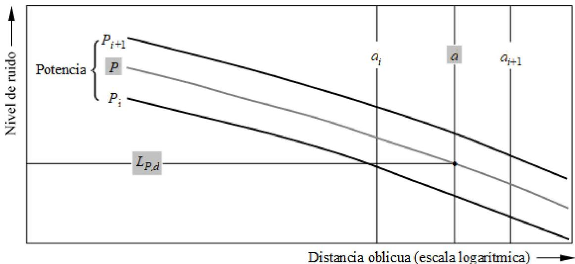
Si  $P_i$  y  $P_{i+1}$  son valores de potencia del motor para los que se tabula el nivel de ruido con respecto a los datos de distancia, el nivel de ruido  $L(P)$  a una distancia determinada para la potencia intermedia  $P$ , entre  $P_i$  y  $P_{i+1}$ , resulta de:
