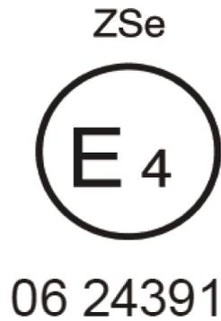
El cinturón que lleve la marca de homologación que figura arriba forma parte de un sistema de retención («Z») y es un tipo de cinturón especial («S») equipado con un absorbedor de energía («e»). Se homologó en los Países Bajos (E 4) con el número 0624391; el Reglamento ya incorporaba la serie 06 de enmiendas cuando se expidió la homologación.
