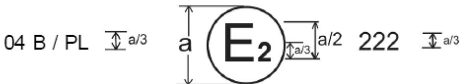
Las figuras 2a y 2b indican que el dispositivo es una luz antiniebla delantera homologada en Francia (E2) con el número 222 conforme al Reglamento nº 19, que incorpora una lente de material plástico y no puede encenderse al mismo tiempo que ninguna otra luz con la que pueda estar recíprocamente incorporada.
