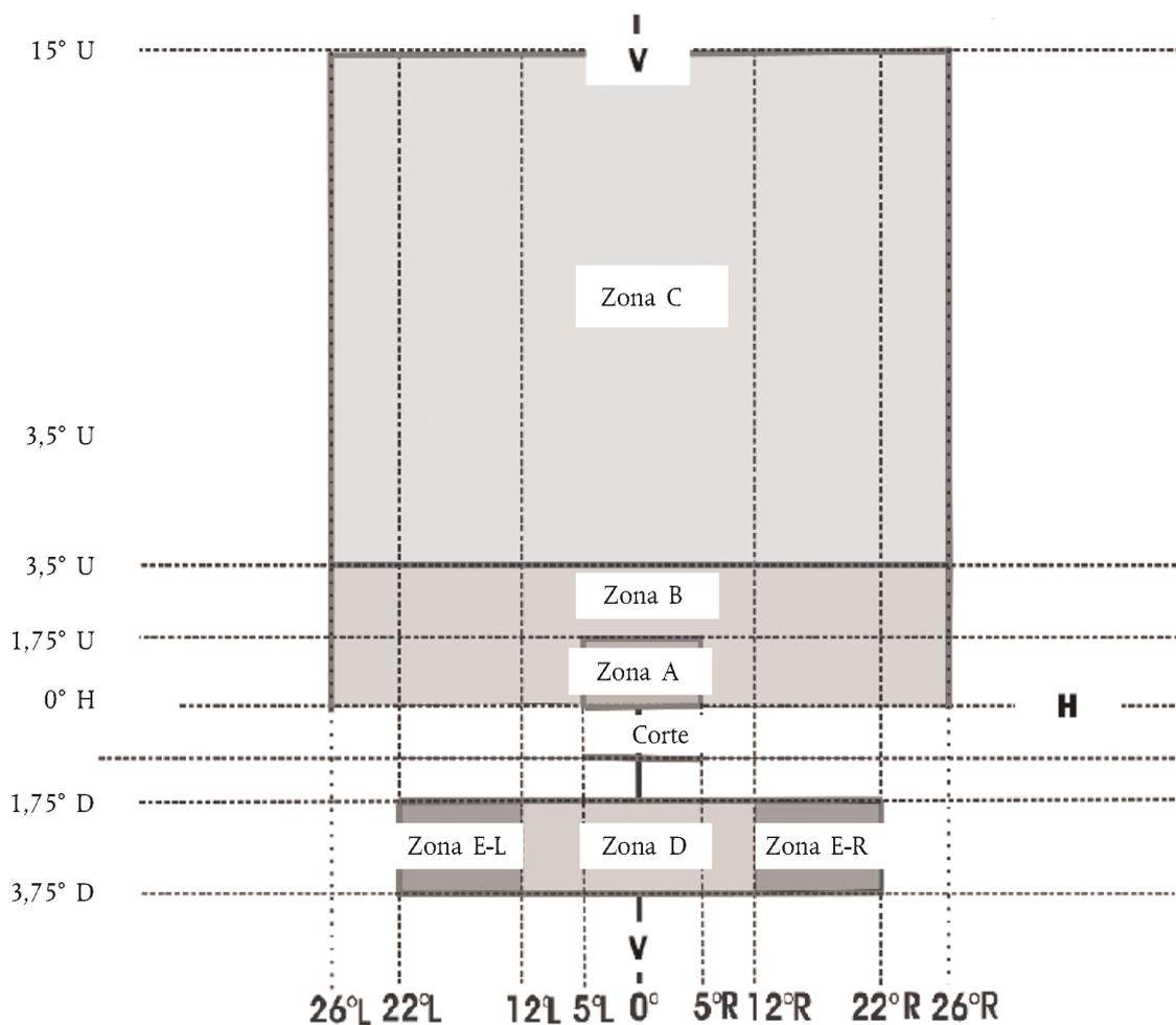
2.2. En la figura 3 se muestra la cuadrícula de medición para luces antiniebla delanteras de la clase «F3».
