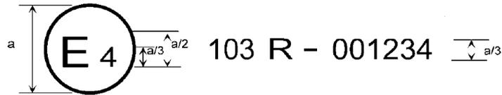
Esta marca de homologación colocada en un componente de un catalizador de recambio indica que el tipo correspondiente ha sido homologado en los Países Bajos (E 4) con arreglo al Reglamento nº 103 con el nº de homologación 001234. Las dos primeras cifras (00) del número de homologación indican que ésta ha sido concedida de conformidad con los requisitos de la versión original del Reglamento nº 103.
