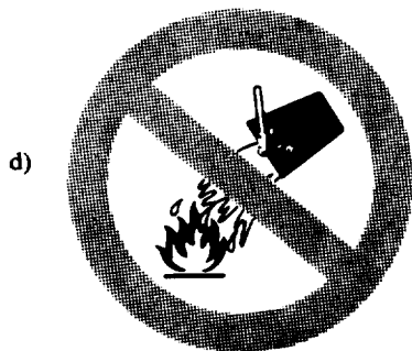
Prohibido apagar con agua
