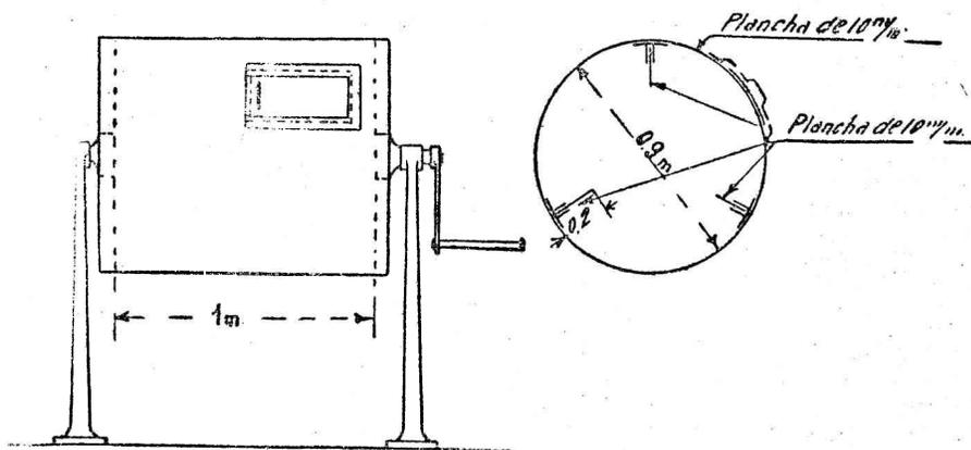
**Piedras o briquetas.**—Se escogen briquetas o piedras y se parten en trozos de 500 gramos de peso aproximadamente. De estos trozos se toman 50 kilogramos, que se prueban en un cilindro de plancha de 10 milímetros de espesor, 0,90 metros de diámetro y un metro de largo.
