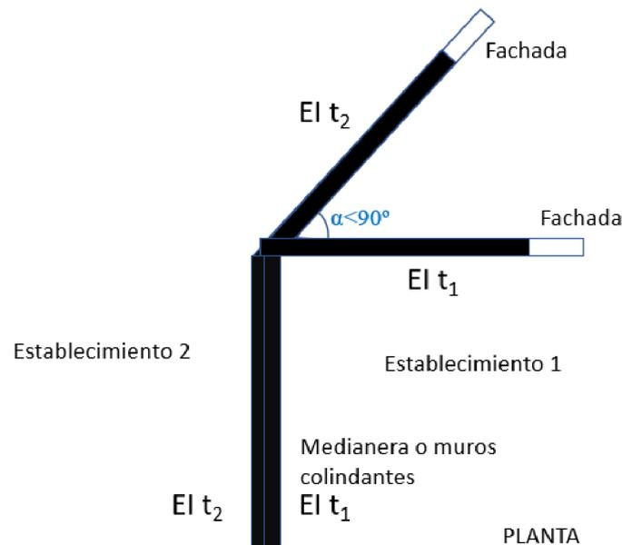
Figura 2.8: Compartimentación entre dos establecimientos con fachadas en ángulo  $\alpha < 90^\circ$
