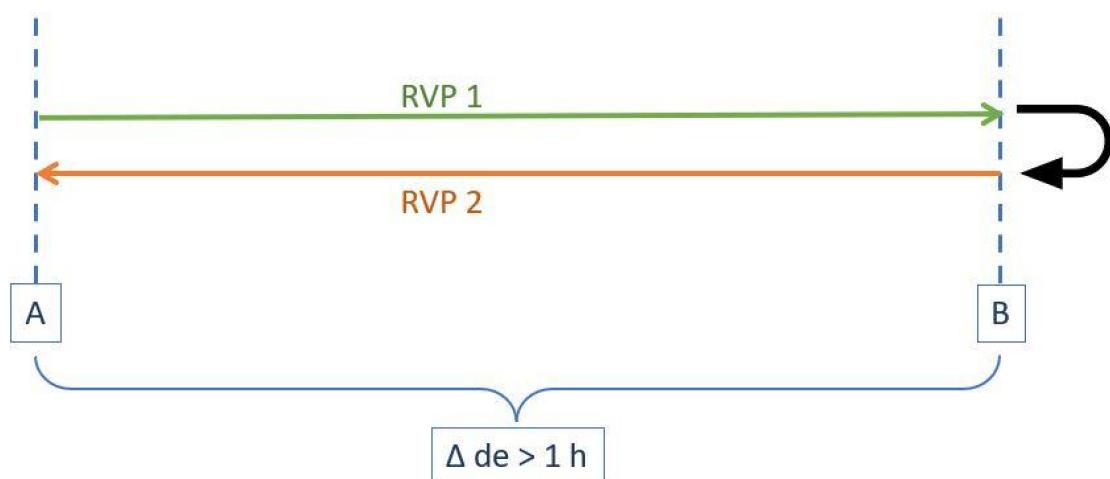
Cada repetición debe realizarse a revoluciones constantes de motor, con una configuración en el vehículo como si se estuviera realizando una labor en campo.
