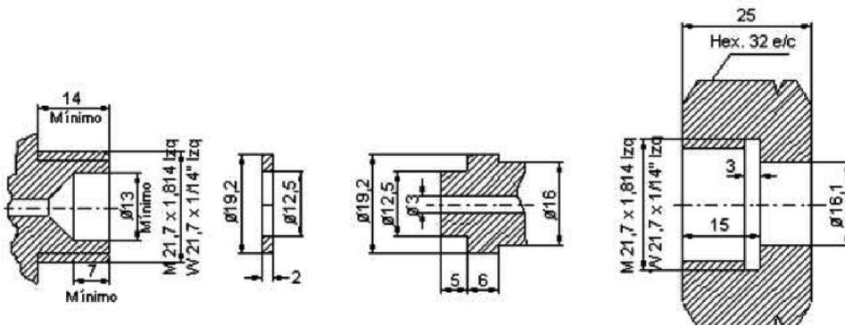
ACOPLAMIENTO M.21,7 x 1,814 MÉTRICO (IZQUIERDAS).
