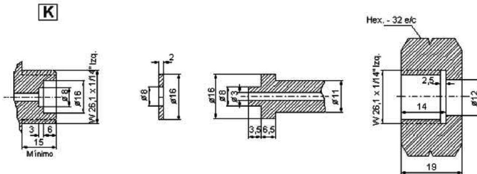
**ACOPLAMIENTO W 26,1-14 Hilos/Pulgada (IZQUIERDAS). TIPO ALTAMENTE CORROSIVOS.**
