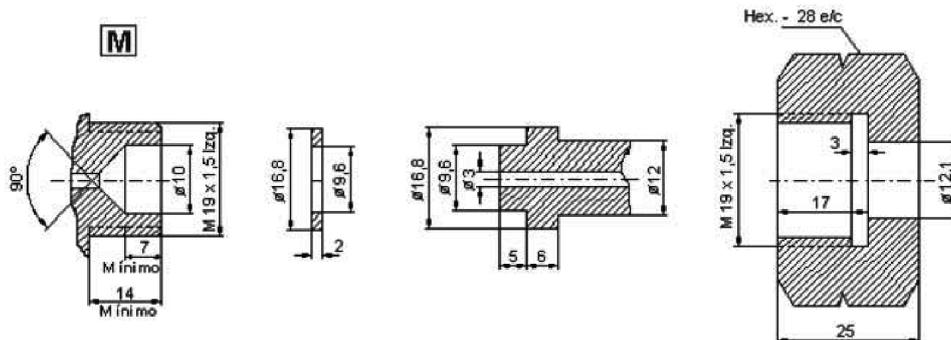
**ACOPLAMIENTO M 19 x 1,5 MÉTRICO (IZQUIERDAS). TIPO MEZCLAS CALIBRACIÓN.**
