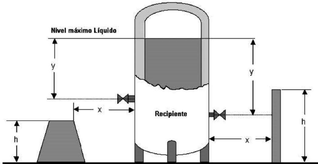
x = Distancia de la pared exterior del depósito a la pared exterior del cubeto en metros.
