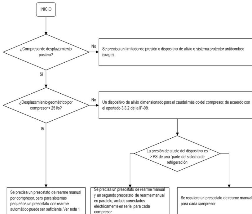
Nota 1: Para sistemas de pequeño tamaño, con carga de refrigerante inferior a 100 kg de la clase A1 o 30 kg para la clase A2L o 5 kg para la clase A2 y A3, se considera que un presostato con rearme automático es suficiente, puesto que su automaticidad no comporta un incremento del riesgo de seguridad.
