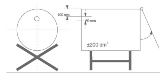
d) colocar sobre un soporte metálico de 200 x 200 mm una vela de cera de parafina de 20 a 40 mm de diámetro y 100 mm de altura; deberá sustituirse la vela cuando su altura se reduzca a menos de 80 mm; la llama de la vela se protege de la acción del aerosol mediante un deflector de 150 mm de ancho y 200 mm de alto. Este incluye un plano inclinado a 45  $^{\circ}$  que se extiende a partir de 150 mm desde la base del deflector (figura 3.2.2);
