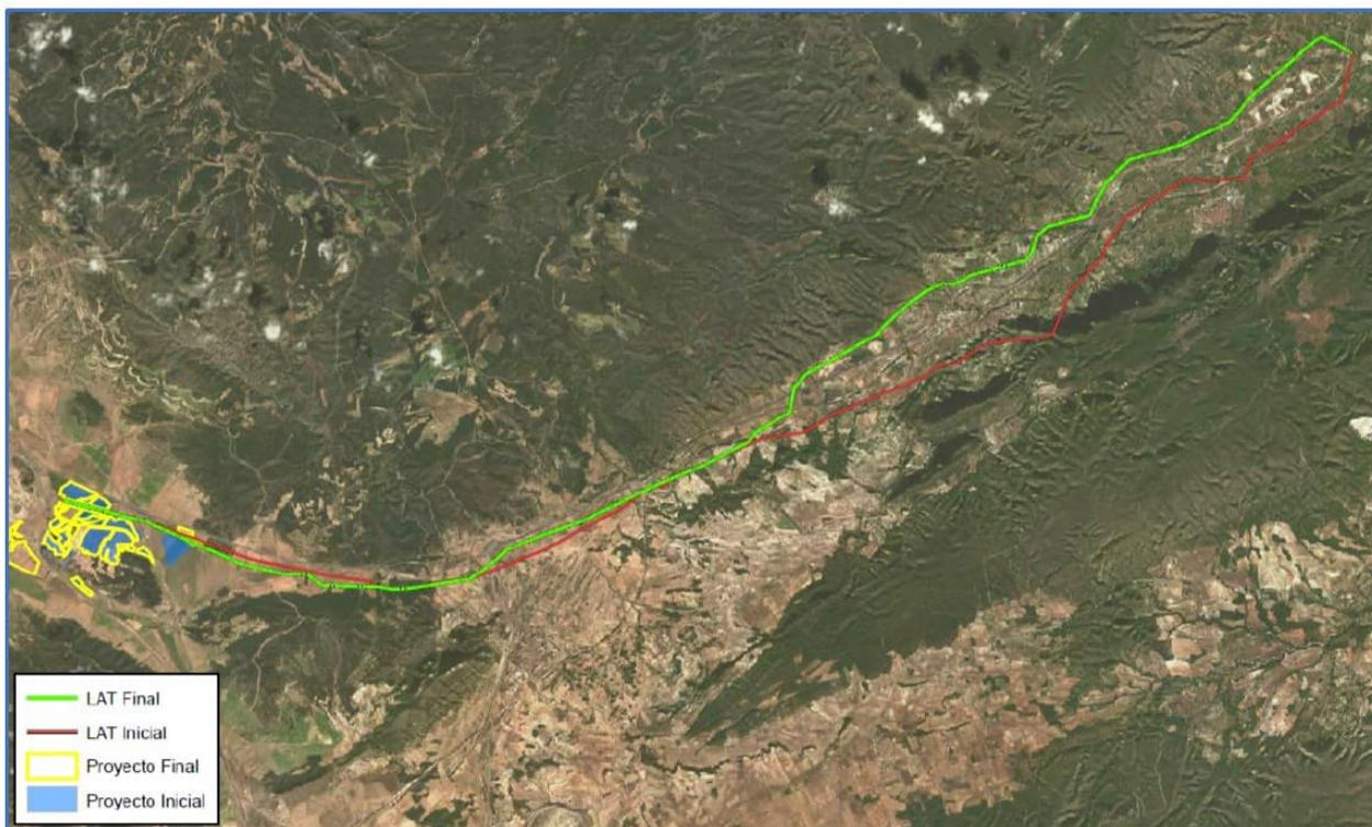
Figura 1. Comparación de los trazados de la LAAT de la 1.<sup>a</sup> (rojo) y 2.<sup>a</sup> IP (verde) y de la implantación de la PSFV, 1.<sup>a</sup> IP (azul) y las 2.<sup>a</sup> IP (amarillo) (Fuente: documentación adicional diciembre 2022)
