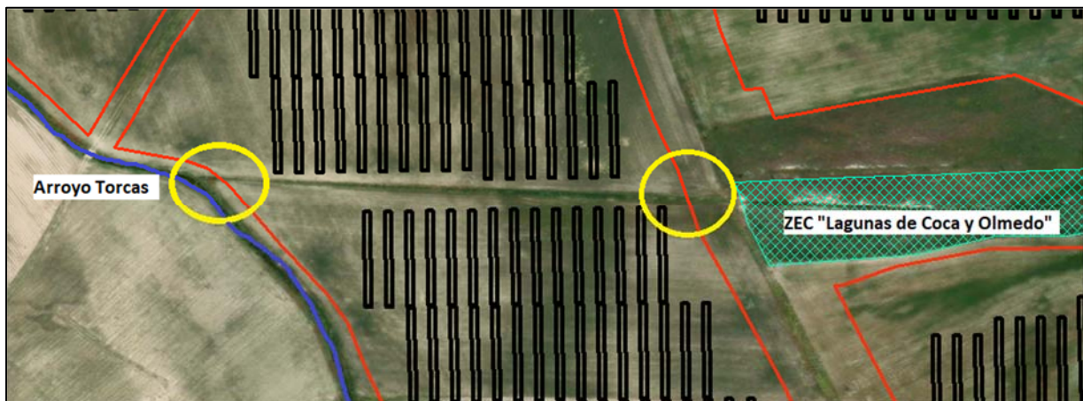
Imagen 1. Intercepción del DPH de arroyo tributario del arroyo Torcas por parte del vallado del recinto «Zona 6» de la PSFV Las Campaneras
