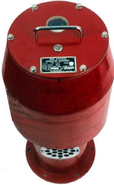
Diseñado específicamente para su instalación en boyas, este dispositivo produce la energía eléctrica necesaria para la iluminación de la lámpara señalizadora por medio de una turbina eléctrica que gira accionada por las compresión y depresión del aire producida dentro de un tubo por el movimiento ascendente y descendente de las olas.
