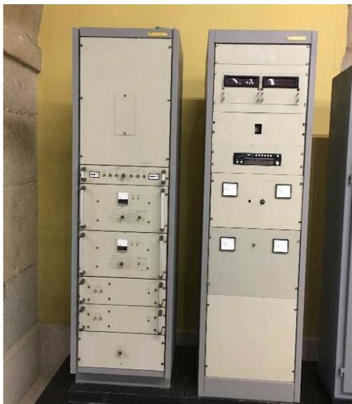
Radio Faro LB100. Transmitía en código morse las letras ba ( - ... - ), en coordinación con los instalados en Cabo Peñas y Llanes. Fue sustituido por una estación GPS, en el año 1973.
