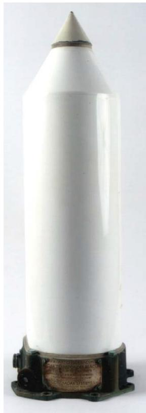
Los Racones son balizas activas de radar que se colocan en puntos de interés para la navegación y que a las señales de radar del buque devuelven un eco en código Morse en forma de brillantes puntos y rayas sobre la pantalla visualizadora, permitiendo la identificación inequívoca del lugar.
