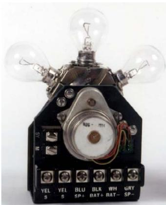
**Otros datos:** Cambiadores de 6 lámparas prefocus. Accionamiento por resorte. Capacidad de 10 A. 12 V. Y Modelo APCL 10. Accionamiento por motor. Capacidad de 10 A de 10 a 30 V **Fabricantes:** CR Control System Inc. (USA) y Automatic Power Inc. Medidas de 9 X 9 x 12 cm. y 10 X 10 x 14 cm. **Origen:** Puertos del Estado
