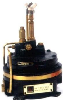
**Otros datos:** Modelo KAG-130 nº 8135, con quemador ZBFA de 15 l. Altura focal 320 mm (regulable), peso 7,5 kgs. Medidas 20 x 20 x 35. Modelo TRAD 100 con quemador ZBFA de 15 l. Altura focal 205 mm, peso 2,5 kgs. Nº 5381B **Medidas:** 14x14x20 Fabricados por la casa sueca AGA **Origen:** Puertos del Estado
