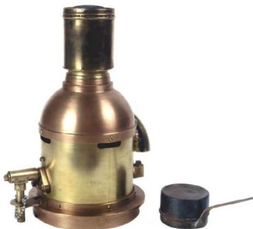
El sistema de iluminación por incandescencia de vapor de petróleo a presión y calefacción interior dio buen resultado y excelente potencia luminosa. Se utilizó en bastantes faros españoles.
