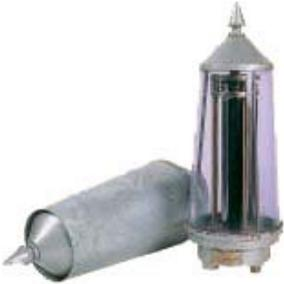
Inventada por el sueco Gustaf Dalen, la válvula solar es un ingenioso dispositivo mecánico empleado en las luces de acetileno que se basa en la dilatación de los materiales por el calor. Por la simple acción de los rayos solares durante el día interrumpe el paso del gas y lo abre al oscurecer, lo que supone un gran ahorro de combustible y permite mayores intervalos en el mantenimiento de los faros automáticos.
