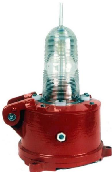
La reducción de peso y tamaño y la sencillez de los equipos actuales utilizados para el balizamiento marítimo puede apreciarse en esta pequeña linterna-óptica construida en policarbonato con base de fundición de aluminio, capaz de alojar en su interior una lámpara provista de doble filamento (uno de reserva) de 2 a 100 w de potencia, un destellador electrónico y el sistema de encendido automático.
