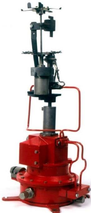
Las llamas producidas por los destelladores de llama desnuda para gas acetileno, conocidas como “cola de pescado” por su apariencia, no eran simétricas en todos sus ejes y variaban de forma e intensidad con las corrientes de aire y con la posición de observación del navegante, alterando el alcance y la distribución de la luz.
