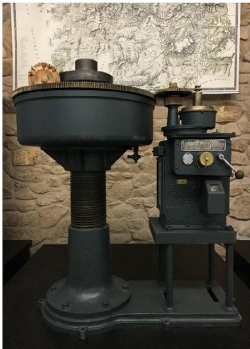
Basamento, cubeta y flotador de mercurio de sustentación de la óptica del faro de Estaca de Bares y máquina de rotación para el giro de la óptica.
