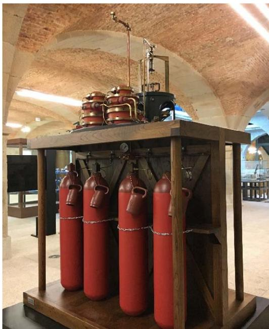
Sistema de iluminación Dallen de gas, compuesto por dos reguladores destelladores de gas (uno de reserva). El cambiador de capillos recibía el gas desde el regulador /destellador y prendía a través de la llama de un pico piloto, que se ponía incandescente, emitiendo así luz. Las botellas de acetileno AK-25 se utilizaban para el suministro de gas.
