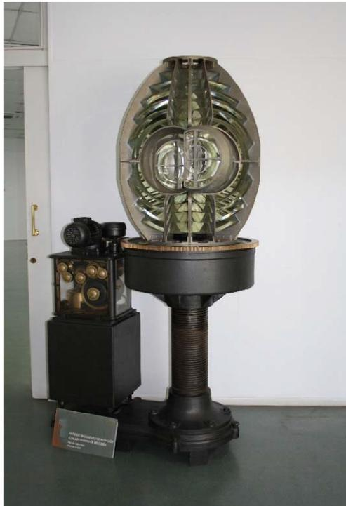
Basamento, cubeta y flotador de mercurio de sustentación de la óptica del faro de Cabo Prior y máquina de rotación para el giro de la óptica.
