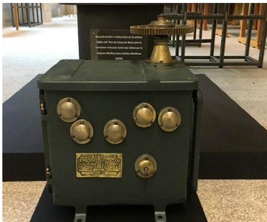
Máquina de relojería para la rotación de la óptica del Faro de Estaca de Bares, que producía el movimiento de un sistema de ruedas verticales y horizontales para el giro de la parte giratoria de la óptica original del faro. Entró en servicio el 16 de septiembre de 1948 para dar mayor velocidad a la rotación y poder dar destellos cada 10 segundos..
