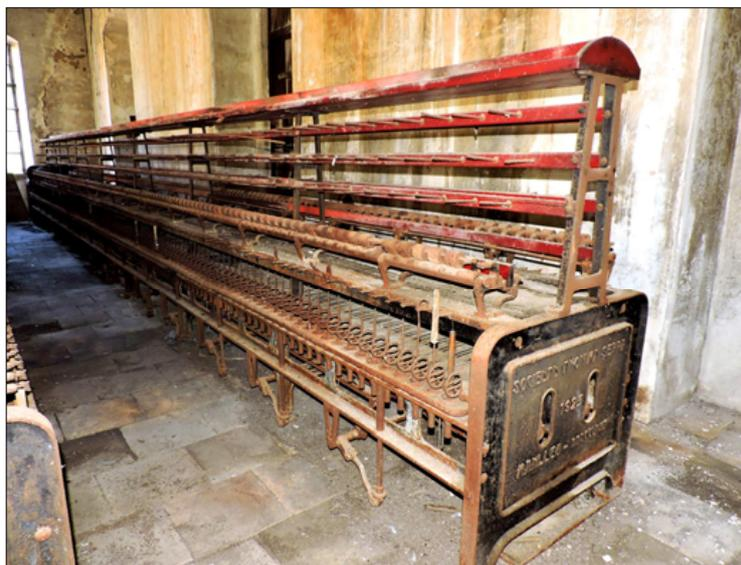
13. Máquina de llenar bobinas manual.
