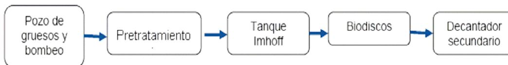
La línea de fangos contará con una arqueta de bombeo de fangos recirculados desde el decantador secundario hasta el tanque Imhoff. Desde éste se conducirán mediante bombeo a un espesador por gravedad. Finalmente, se enviarán a un proceso de deshidratación mediante centrífuga. Se han diseñado dos sistemas de desodorización: el primero para el tratamiento de los olores emitidos desde el edificio industrial y el segundo para los emitidos desde el tanque Imhoff.
