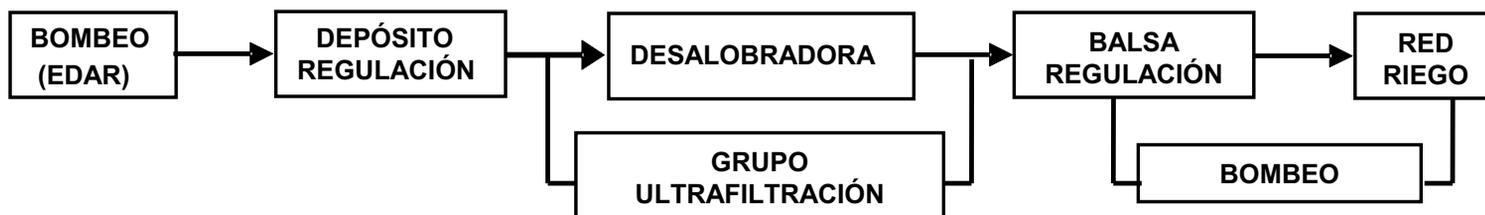
Depósito de regulación.—El depósito de 60 m<sup>3</sup> de capacidad se localiza entre la estación depuradora y la planta desalobradora. Su función es regular los posibles picos horarios de volumen entrante a la desalobradora.
