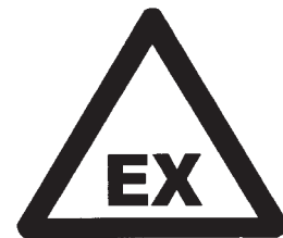
Zona con riesgos de atmósferas explosivas
