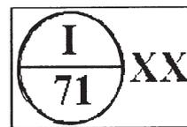
Las dos cifras exteriores al círculo, que se simbolizan con XX, son variables y corresponden a los dos dígitos finales del año en que se efectúa la verificación primitiva.
