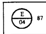
Las dos cifras exteriores al círculo son variables y corresponden a los dos dígitos finales del año en que se efectúa la verificación primitiva.
