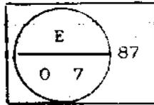
Las dos cifras exteriores al círculo son variables y corresponden a los dos dígitos finales del año en que se efectúa la verificación primitiva.
