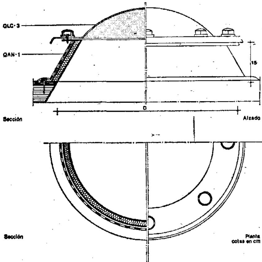
QLC-3 Cúpula circular sobre zócalo prefabricado. Se fijará a la cubierta con clavos separados 30 cm.
