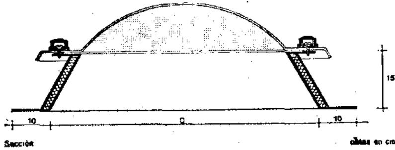
Cúpula y zócalo de material sintético termoestable. Impermeable e inalterable a los agentes atmosféricos. La superficie interior del zócalo será lisa, clara y brillante para facilitar la reflexión de la luz. El sistema de fijación de la cúpula al zócalo, llevará interpuesta una arandela de goma de 5 mm de espesor mínimo y será estanco a la lluvia.
