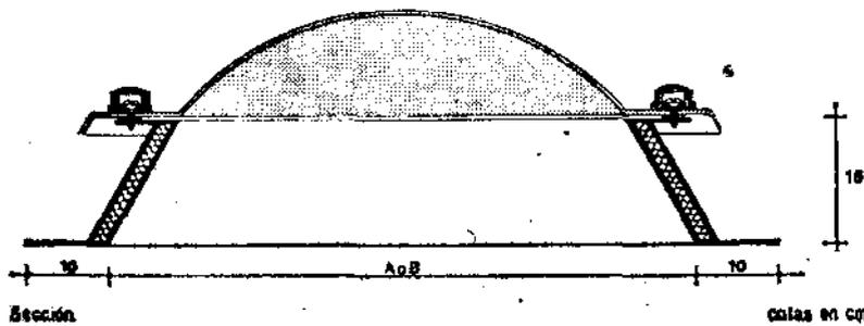
Cúpula y zócalo de material sintético termoestable. Impermeable e inalterable a los agentes atmosféricos. La superficie interior del zócalo será lisa, clara y brillante para facilitar la reflexión de la luz.
