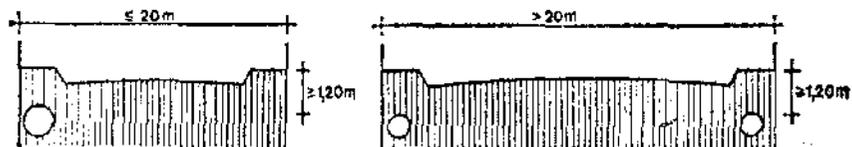
El sistema unitario evacua todo tipo de aguas por un solo conducto. Se utilizará preferentemente.
