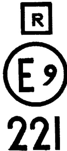
El dispositivo que lleva la marca de homologación anterior es un dispositivo de luz roja posterior homologado en España con el número 221. La ausencia de flecha indica que las especificaciones fotométricas impuestas se cumplen hacia la derecha y hacia la izquierda hasta el ángulo de  $80^\circ$ H.
