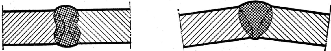
FIG. 2.— SOLDADURAS A TOPE, EN PROLONGACION
