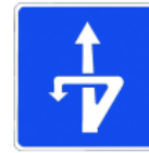
S-25 Cambio de sentido a distinto nivel
