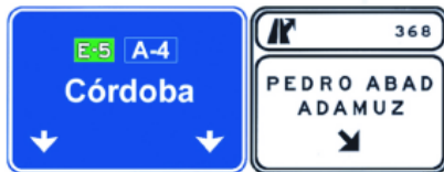
S-366 Señales sobre la calzada, en autopista o autovía. Salida inmediata hacia carretera convencional y dirección propia
