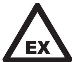
Zona con riscos de atmosferas explosivas
