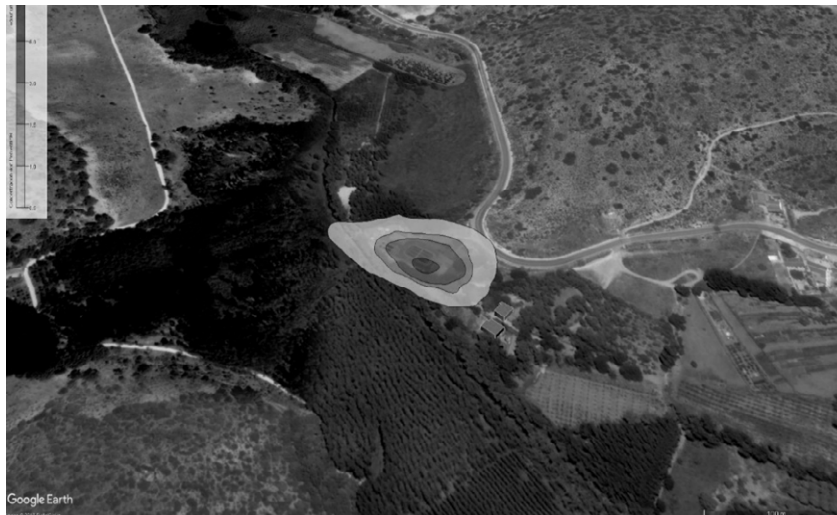
Gráfica 3. Representación de curvas isodoras en el escenario futuro (dando servicio a Ruidera y a los 22 puntos de vertido) con cubrición del tratamiento biológico y desodorización
