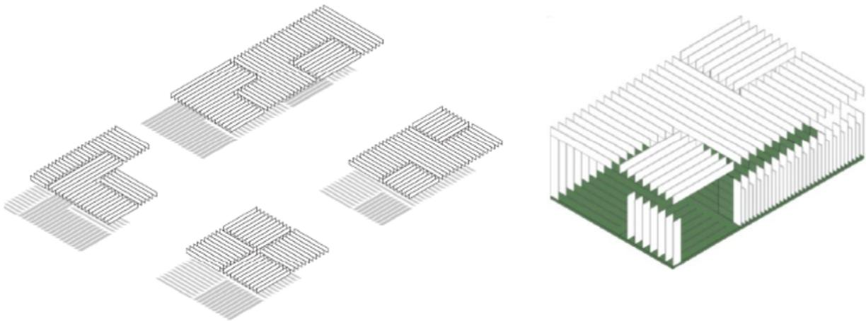
La propuesta consiste en el diseño de un TECHO SUSPENDIDO que reproduce un cruce de diversas tramas de líneas paralelas.
