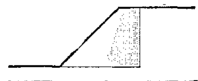
2c Talud y bataches
