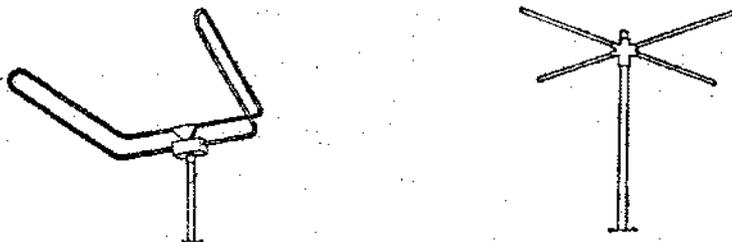
Constituida por elementos de aluminio fijados a un soporte. Llevará incorporada caja de conexión con adaptador de impedancia y elemento de fijación al mástil. Se indicará la marca, tipo, ganancia F en dB y número de homologación de la Dirección General de Radiodifusión y Televisión.
